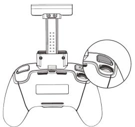
Fig 4-8 Customizable Button Fn
